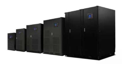
AEU 系列为一款在线式三相输入双变换系统的大功率工频 UPS。实行全数字化控制,速度快、精度高、系统稳定性好,对电池系统充放电进程实行全程监控、智慧化管理。 完善的滤波电路可以滤除输入市电杂波,给负载提供纯净的正弦波电力,并在输出端配置工频隔离变压器,进一步提高了电源的过载能力、抗冲击能力和使用寿命。
